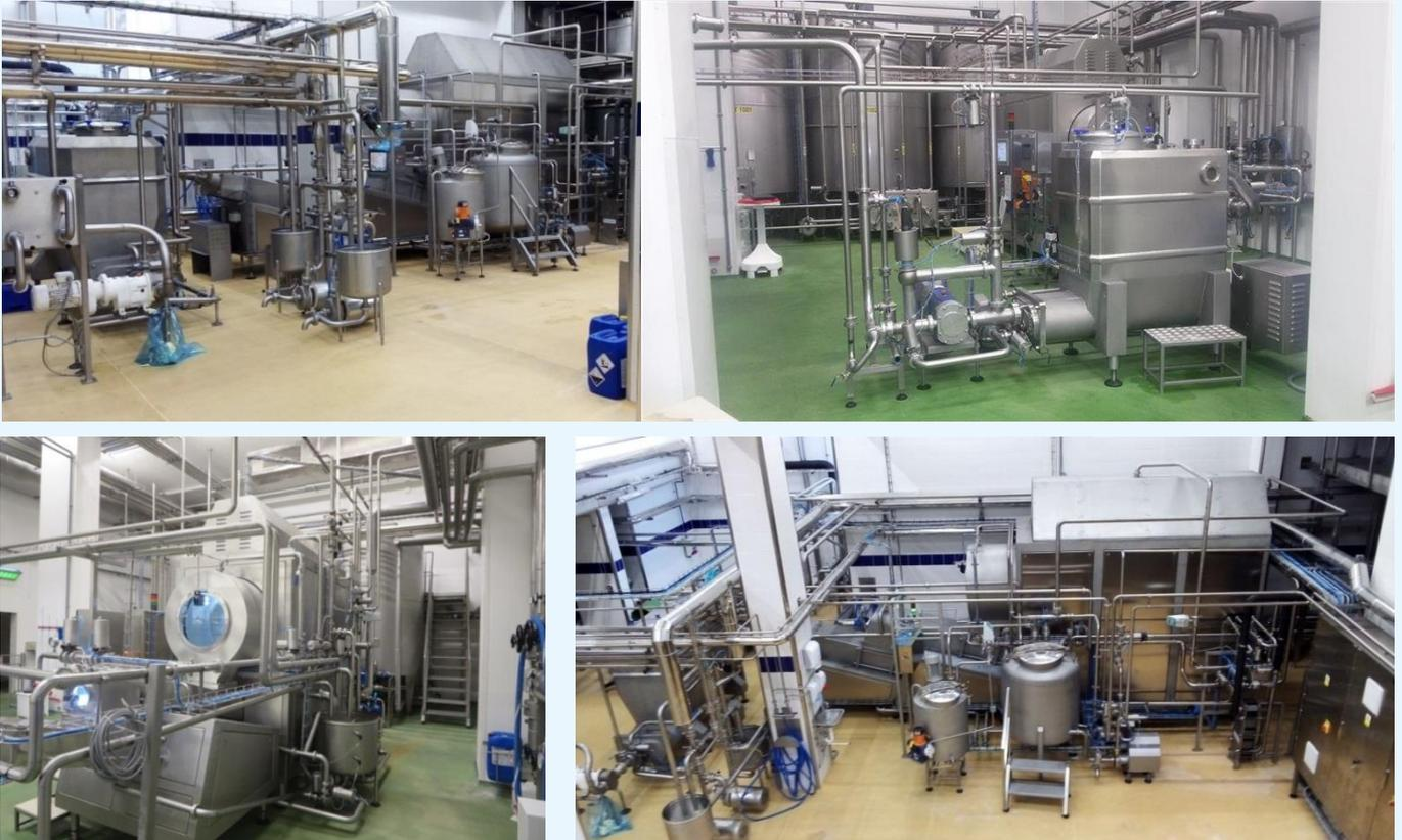
Линии для производства масла компании «В е Н о spol. s r.o.» управляются с высокой степенью автоматизации, такие режимы, как мытье и санация, полностью автоматические. Центральная система управления предоставляет всю важную информацию о процессе производства и параметрах масла.
